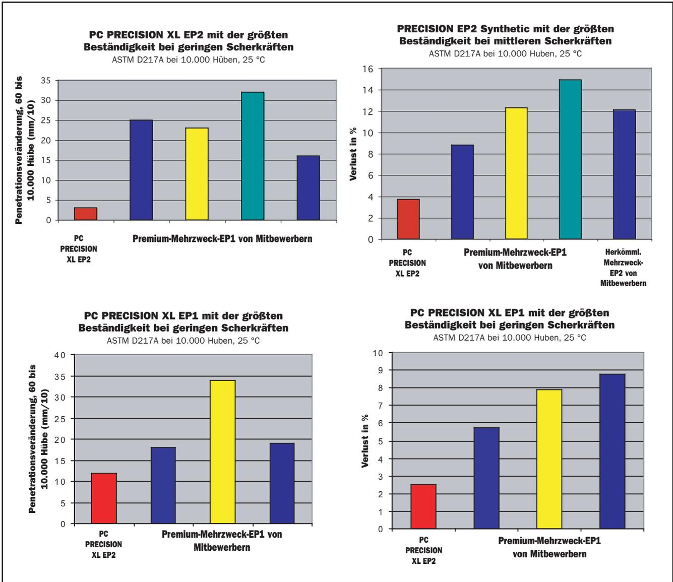
\* Die Tests bemessen die Stabilität des Schmierfetts unter Einwirkung von normalen und mittleren Scherkräften. Je geringer der Wert im Diagramm, desto höher die Leistung und länger die Nutzungsdauer des Schmierfetts.
